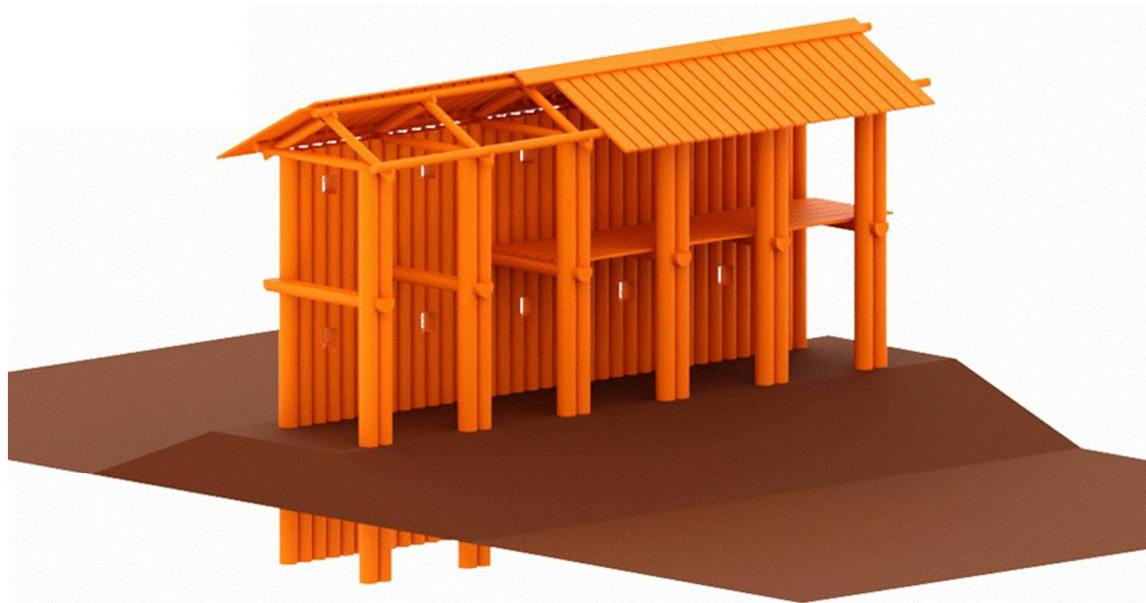
Рис. 6. 3D-модель общего устройства полевых стен острога Fig. 6. 3D model of the general structure of the fort's field walls
