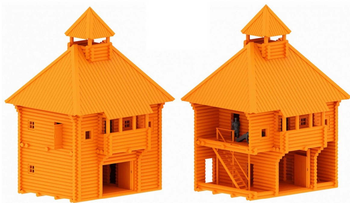
Рис. 9. 3D-модель устройства проездной башни (вид со стороны дороги) Fig. 9. 3D model of the gate tower construction (view from the side of the road)
