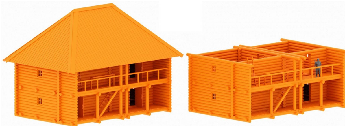
Рис. 12. 3D-модель общего устройства Албазинского Воскресенского амбара Fig. 12. 3D model of the general structure of Albazin Voskresensky barn
