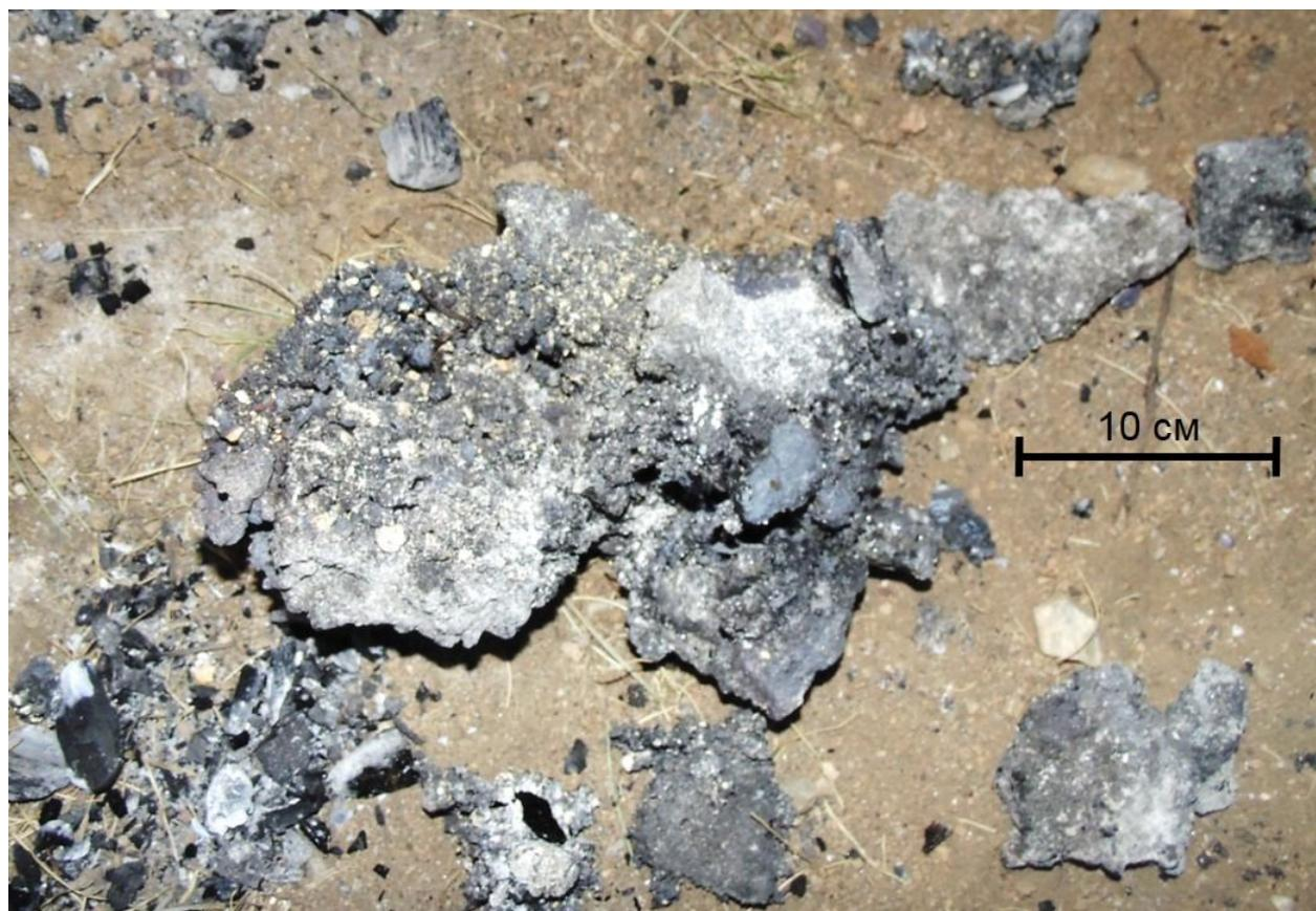
*Рис. 8. Слабоспеченный горновый материал, получившийся в ходе эксперимента № 1*
