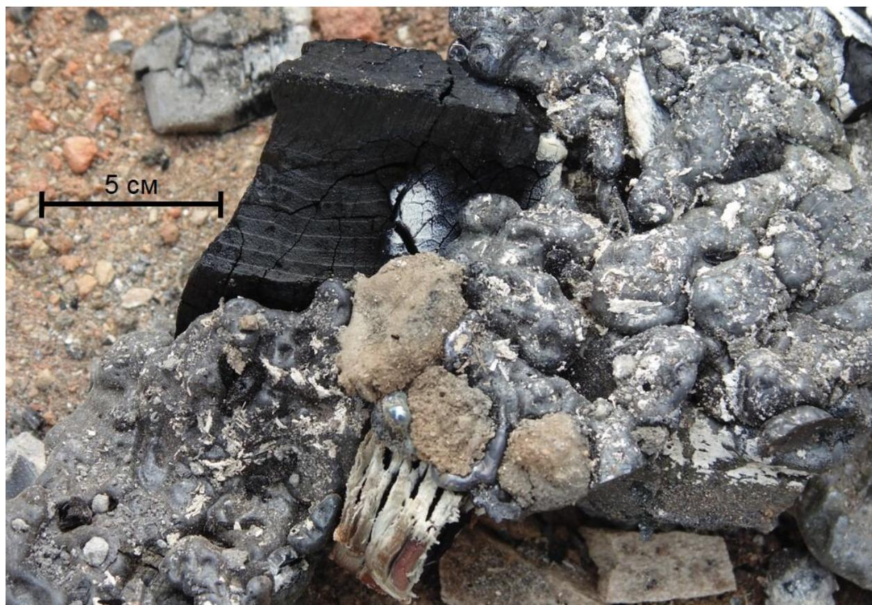
*Рис. 11. Горновый шлак, образовавшийся в ходе эксперимента № 2*
