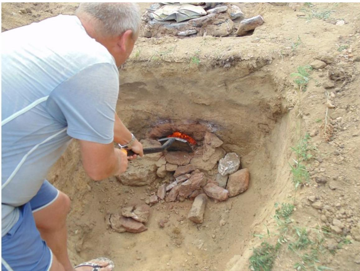
*Рис. 7. Вскрытие нижней фурмы горна в ходе эксперимента № 1*
