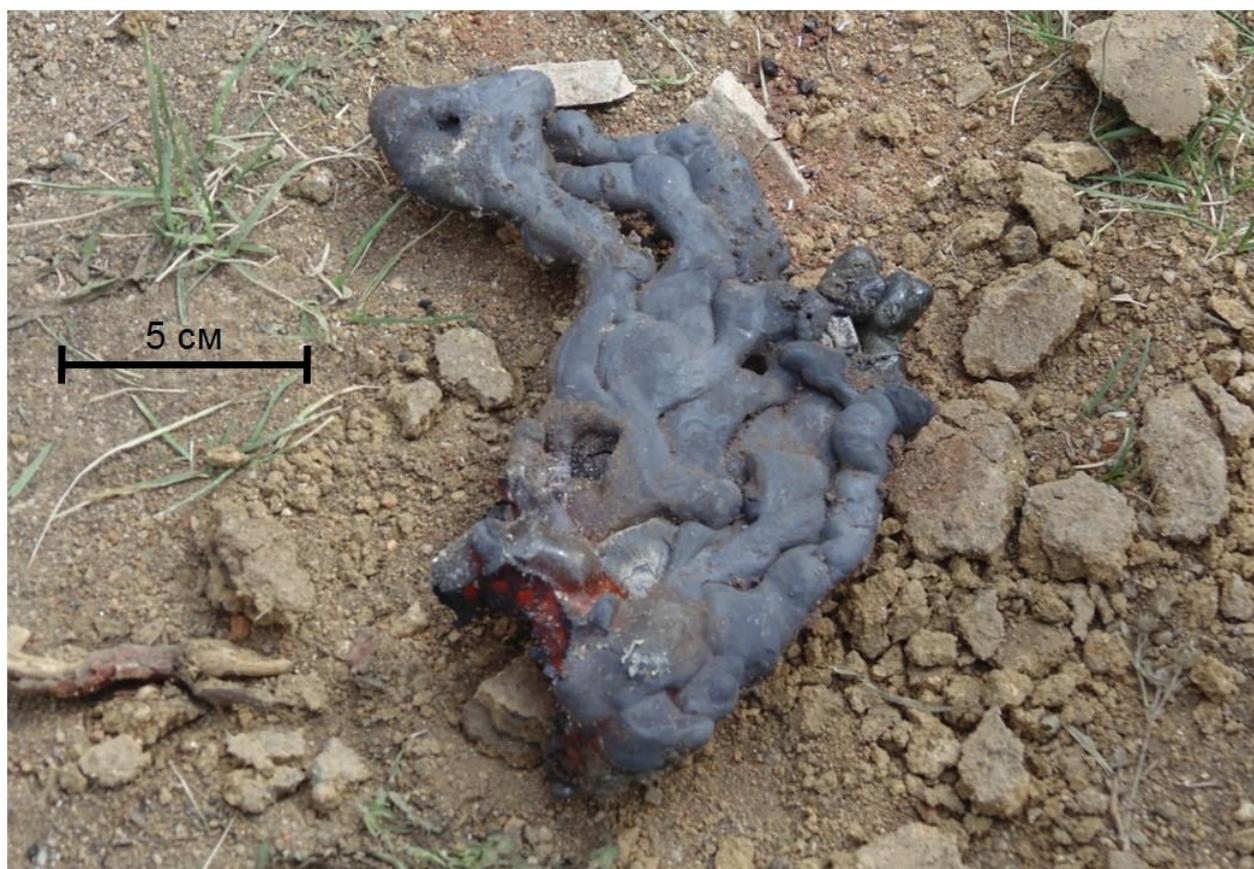
*Рис. 10. Железосиликатный шлак, вытекший из горна в ходе эксперимента № 2*
