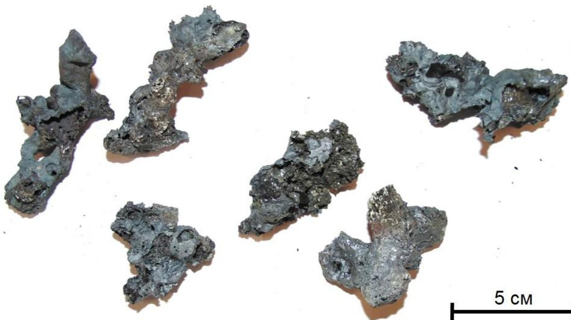
*Рис. 12. Губчатое железо (крица), образовавшееся в ходе эксперимента № 2*
