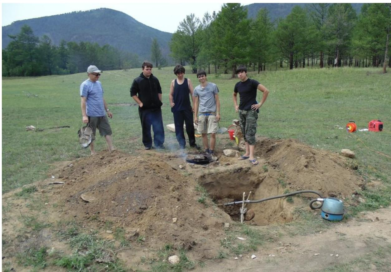
*Рис. 9. Поддув воздуха с помощью бытового пылесоса в ходе эксперимента № 2*
