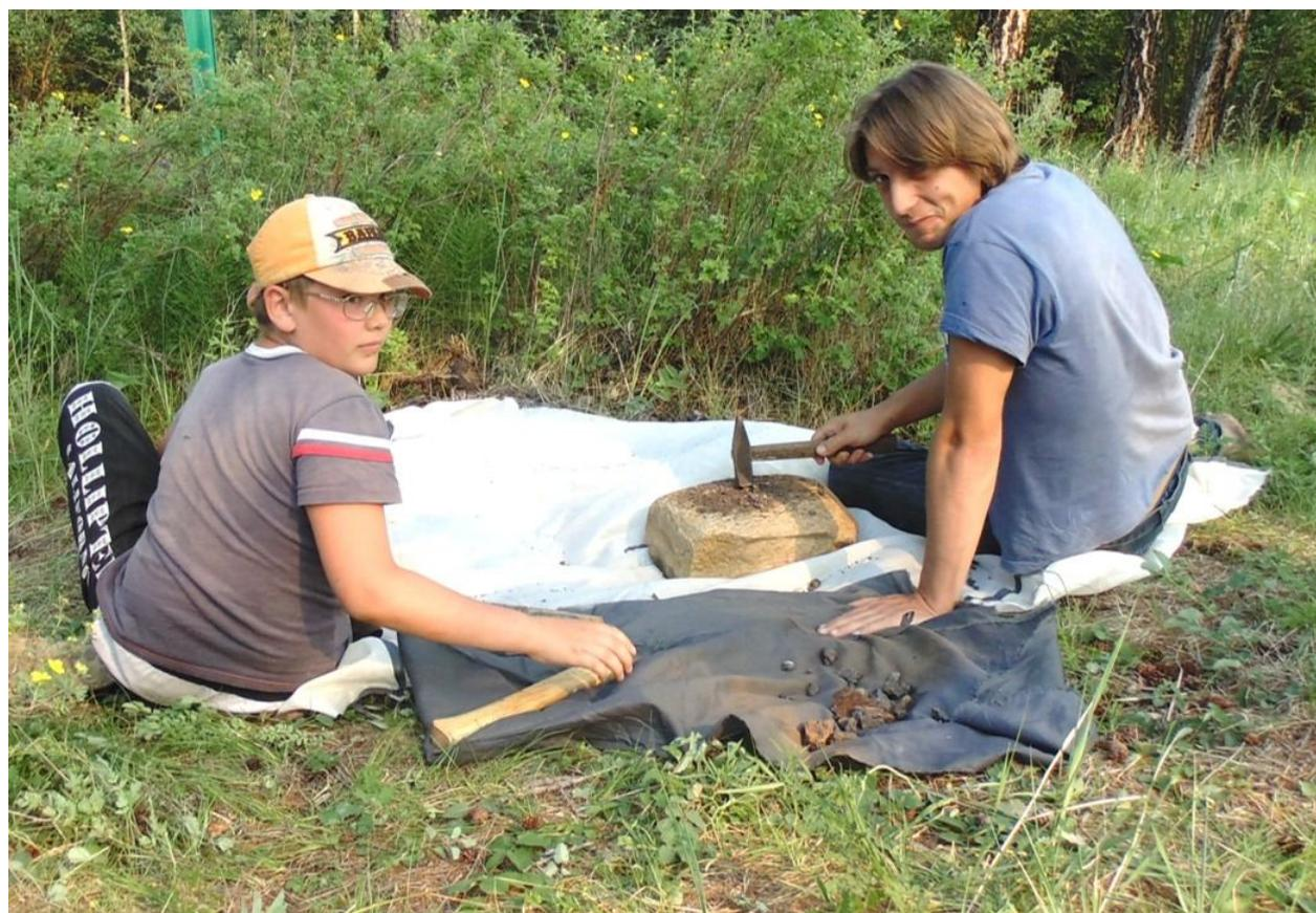
*Рис. 6. Дробление руды до размера зерен крупного песка*
