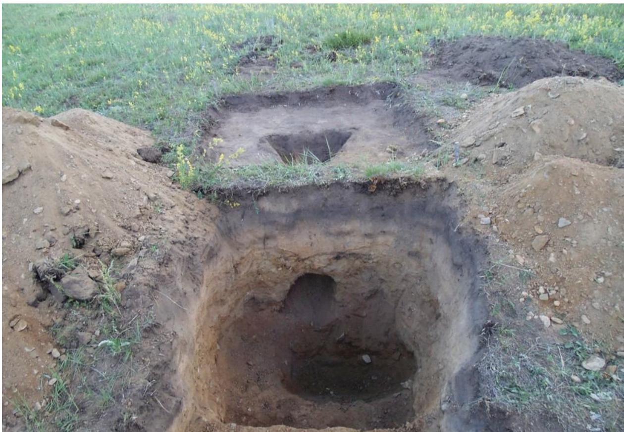
*Рис. 2. Воронкообразная рабочая камера сыродутного горна*
