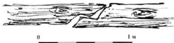
Рис. 16. Иркутский водоотвод. Способ перевязки стыков бревен (рисунок с натуры)
